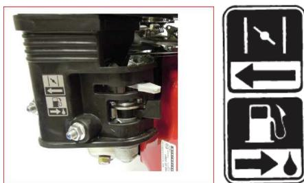
*Figura 8 Rubinetto benzina e comando starter*
