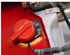
*Figura 9 Comando spegnimento motore*
