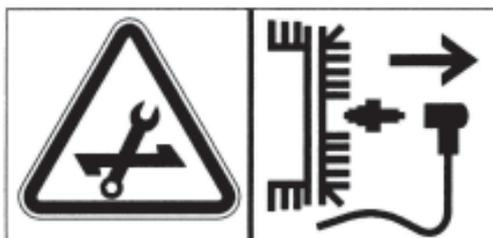
Attenzione. Durante la manutenzione staccare sempre il cavo della candela del motore
