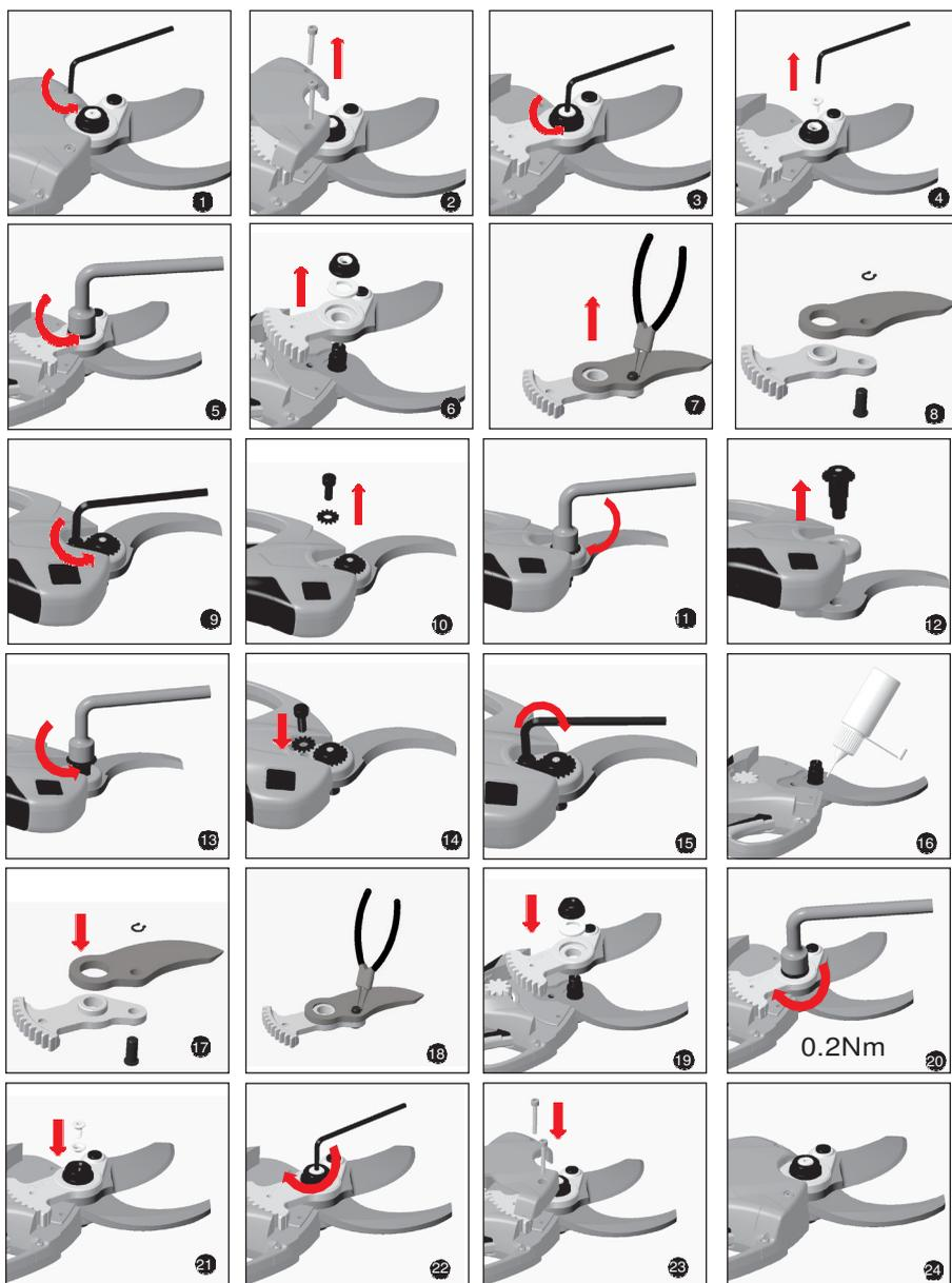
NOTA: Le lame fisse e mobili possono essere sostituiti singolarmente. Non dovresti preoccuparti delle dimensioni dell'apertura della lama del coltello sostitutivo poiché, una volta che la lama è stata sostituita, quando attivata tornerà automaticamente alla sua dimensione originale.
